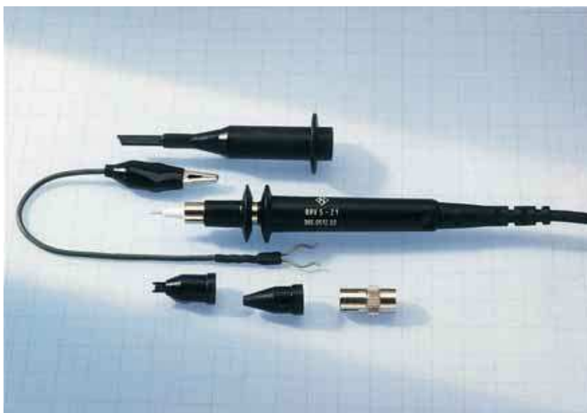
DC-Tastkopf R&S® URV5-Z1, 1 mV bis 400 V, 3 pF // 9 MΩ
